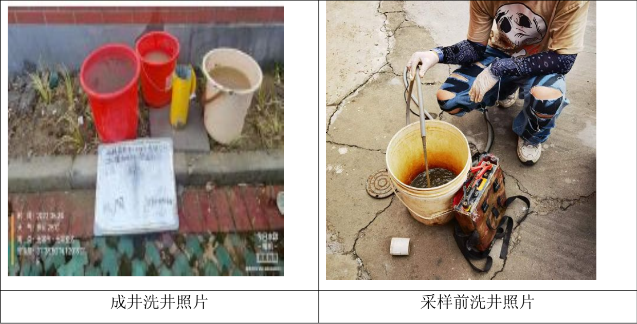
图 7.2-7 洗井工作照片（现场照片）
